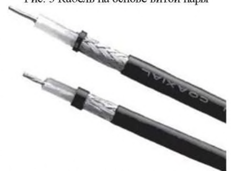
Рис. 4. Устройство коаксиального кабеля 1 — внутренний проводник (медная проволока), 2 — изоляция (сплошной полиэтилен), 3 — внешний проводник (оплетка из меди), 4 — оболочка (светостабилизированный полиэтилен).
