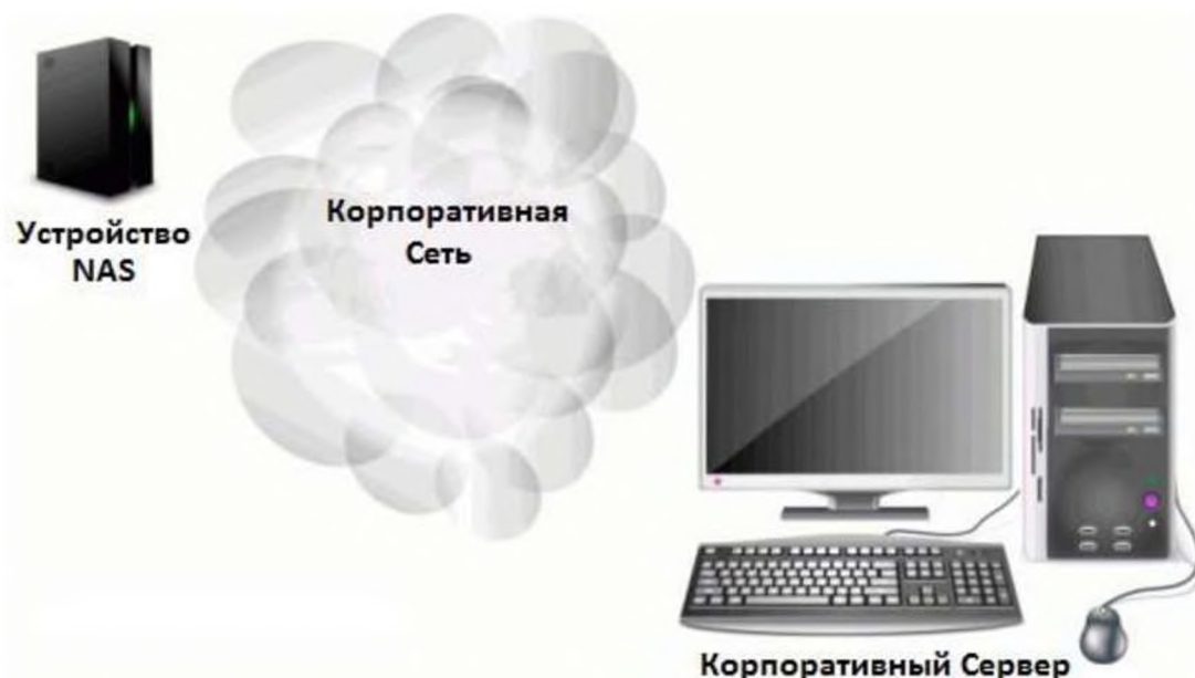
Рис.1. Рекомендуемая схема сети при резервном копировании небольшого корпоративного сервера
