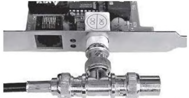
Рис. 2. Т-коннектор, присоединенный к сетевой карте
